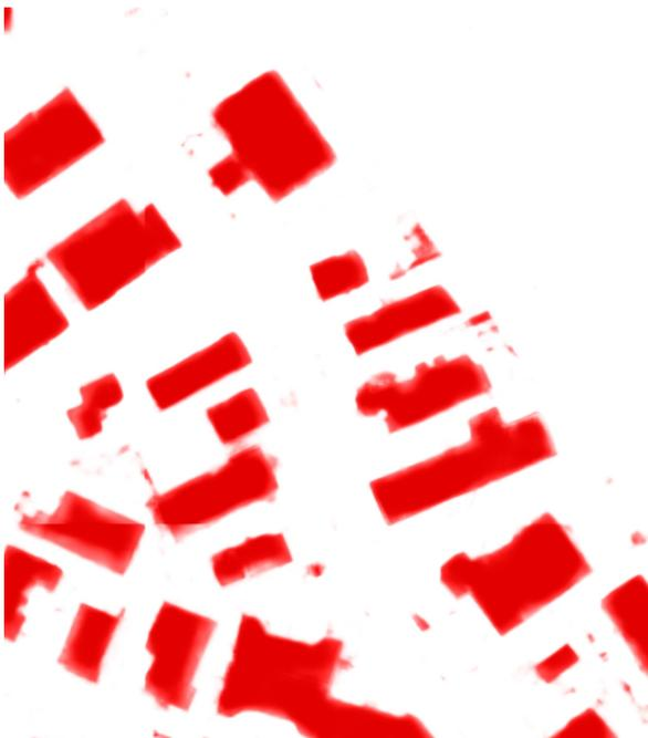
Sur cet exemple, plus un pixel est foncé, plus le modèle est confiant dans le fait qu'il se situe sur du bâti.
