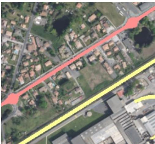
Ossature créée par dilatation des tronçons du réseau principal de la BD TOP®.
