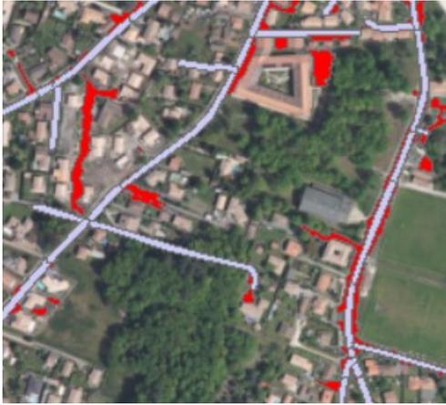
Sont représentés en mauve les éléments de l'ossature dérivés des réseaux BD TOP®, auxquels on a adjoints les parties en rouge, calculées par *deep learning* . On obtient le produit **ORHFB Merge**.
