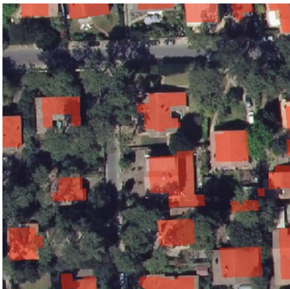
Segments (polygones orange) correspondant aux bâtiments obtenus par ML à partir d'ortho-images 20cm
