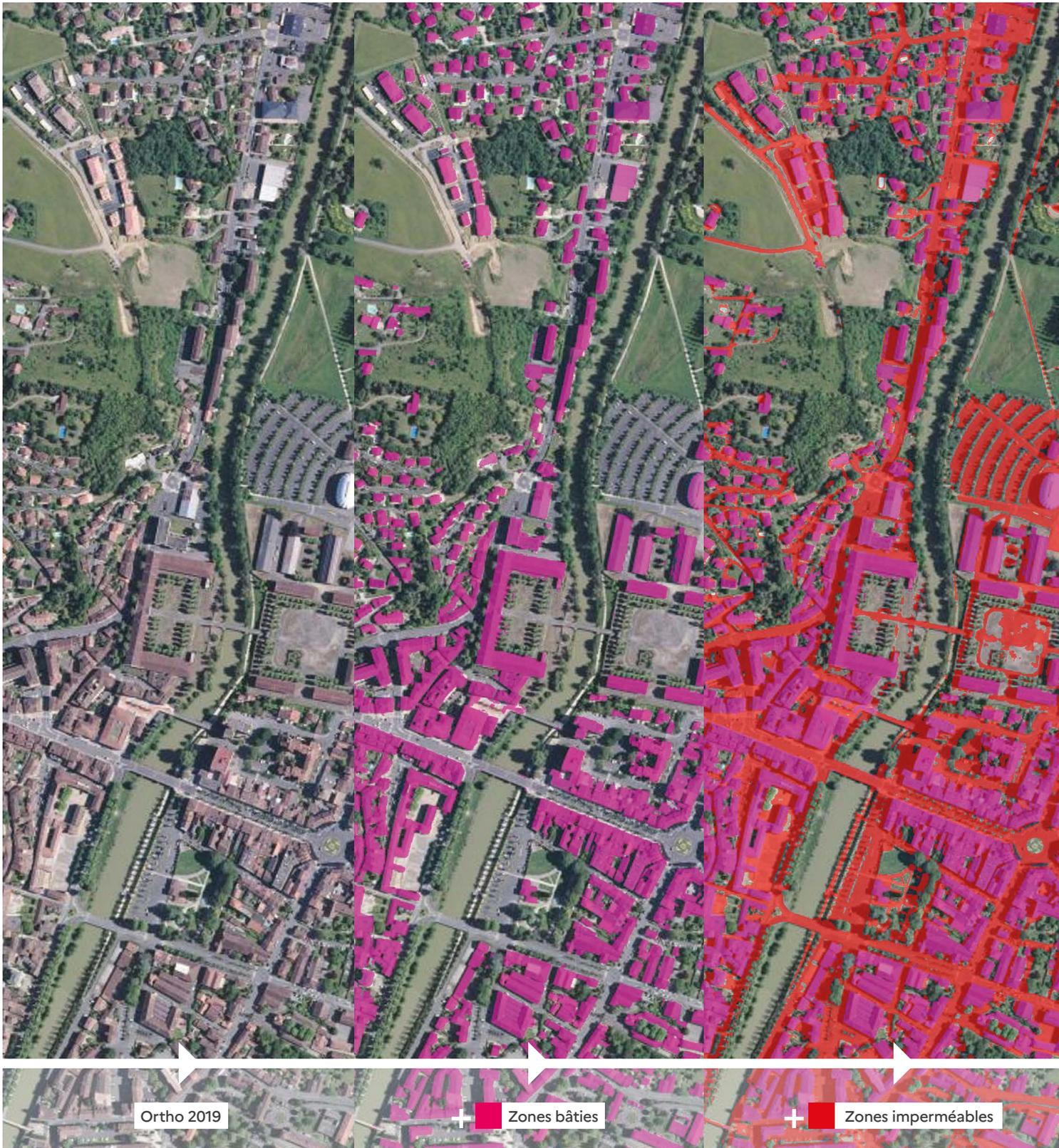
De gauche à droite : vue aérienne (photographie), détection automatique des bâtiments, puis détection automatique des zones imperméables non bâties
